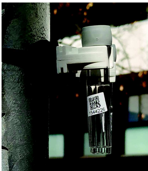
Figura 2: Dosímetre passiu de NO 2 del tipus Palmes.
